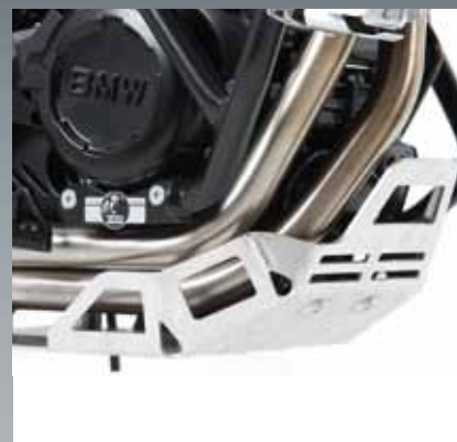
Skid plate Item 810.653
